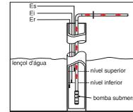
**4.1 - Função N:** o relé de saída energiza quando o nível máximo for atingido, e desenergiza ao ser atingido o nível mínimo. Aplicação: evitar o funcionamento do equipamento controlado quando o líquido atinge o nível inferior (por exemplo, uma **bomba submersa**, a qual não pode funcionar sem água).
